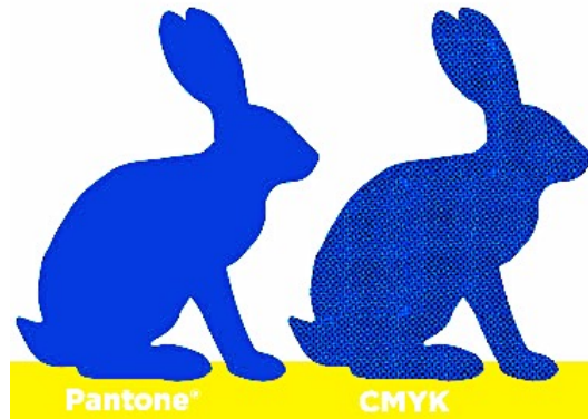
Resim 3. 12. : Solda, CMYK/ proses renk karışımları ile oluşturulmuş bir Pantone mavi tonu ile sağda spot renk karışımı ile direkt olarak oluşturulmuş bir mavi tonu temsili örneği. 78
