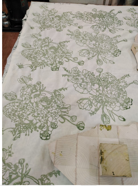
Resim 4. 6.: Desenin Kastamonu'daki baskı ustası tarafından ahşap kalıplar ve anilin boya ile basılma aşamasının görüntüsü.
