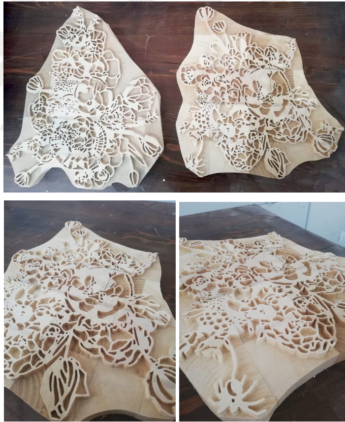
Resim 4. 5.: Ahřap kalıplar, sonulandırılmak istenen desene gre kalıp ustasının kararıyla 2 para olarak yapılmıřtır.
