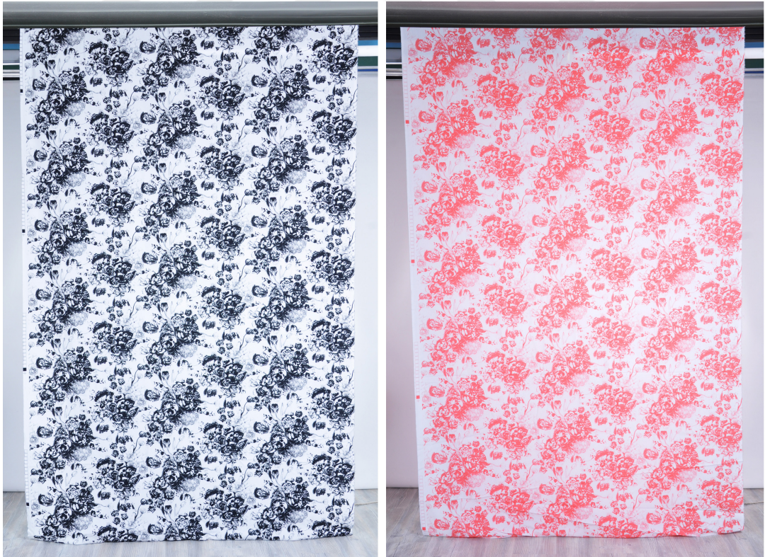
Resim 4. 10.: Desenin solda siyah ve sağda Pantone 178C renkleri ile, tek renkli rotasyon baskı tekniğiyle basılmış görüntüleri.
