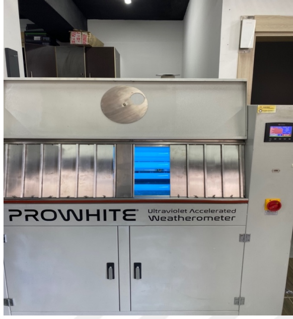
Şekil 15: Kullanılan UV Yaşlandırma cihazı
