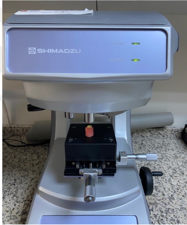
Şekil 6: Mikrosertlik ölçümü (Shimadzu mikrosertlik test cihazı)
