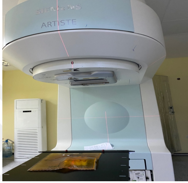
Şekil 7: Örneklerin radyasyona maruz bırakılması
