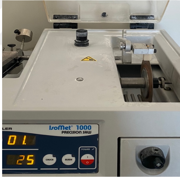
Şekil 9: İzomet cihazında seramik blokların kesilmesi
