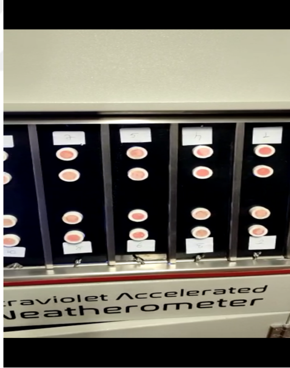
Şekil 13: Örneklerin tutucu parçalara yerleştirilmesi
