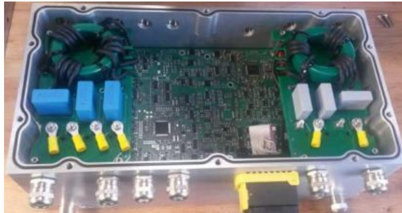
Şekil 1.6: 20 kW’lık şarj modülü (Marzouk 2015).
