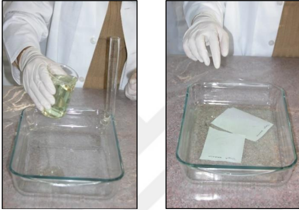
Şekil 2.27. Ninhydrin yönteminin uygulanması.
