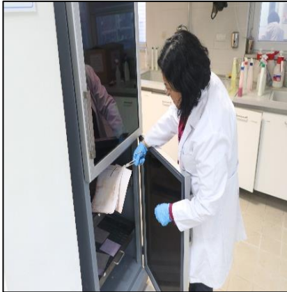
Şekil 2.28. Ninhydrin bekleme kabini.
