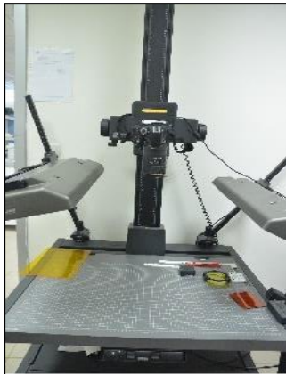
Şekil 2.7. Parmak izi fotoğraf çekim düzeneği.
