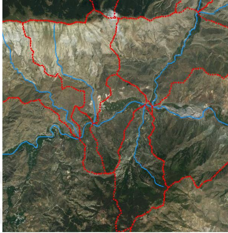
Şekil 3.7. Su toplama alanlarının oluşturulması
