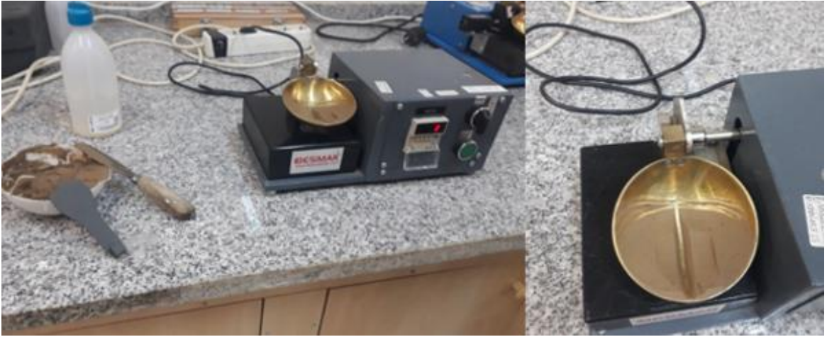
Şekil 7. Casagrande deney aleti ve oluk açma bıçağı tarafından ikiye bölünen numune.
