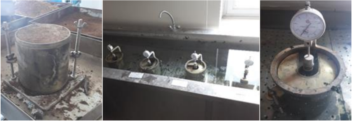
Şekil 12. Hazırlanan ve havuzda bekletilen numune ile havuzdaki numunenin komparatör saati ile takip edilmesi.
