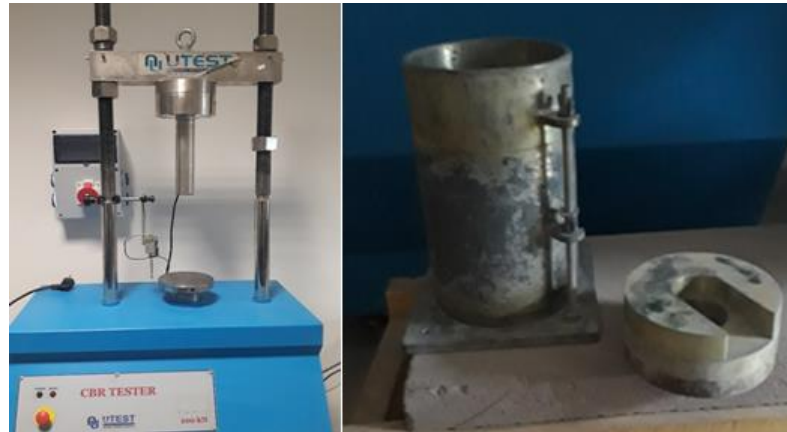
Şekil 11. CBR deney cihazı ile CBR deney kalıbı ve yük diski.
