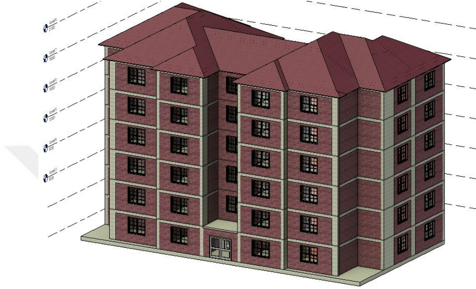
Resim 3.9 Revit aracılığıyla karma tařıyıcı sistem olarak modellenen bina projelerinin 3B izimi (Revit 2021).
