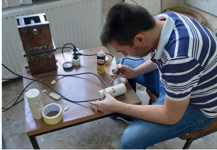
Şekil 5.6. Örneklere deformasyon ölçerlerin yapıştırılması
