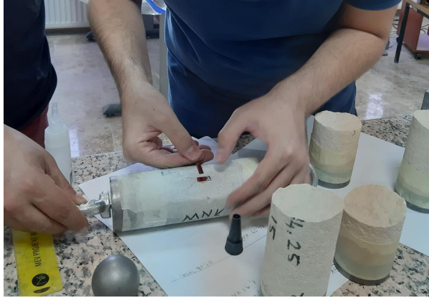
Şekil 5.13. Örneklere deformasyon ölçerlerin yapıştırılması
