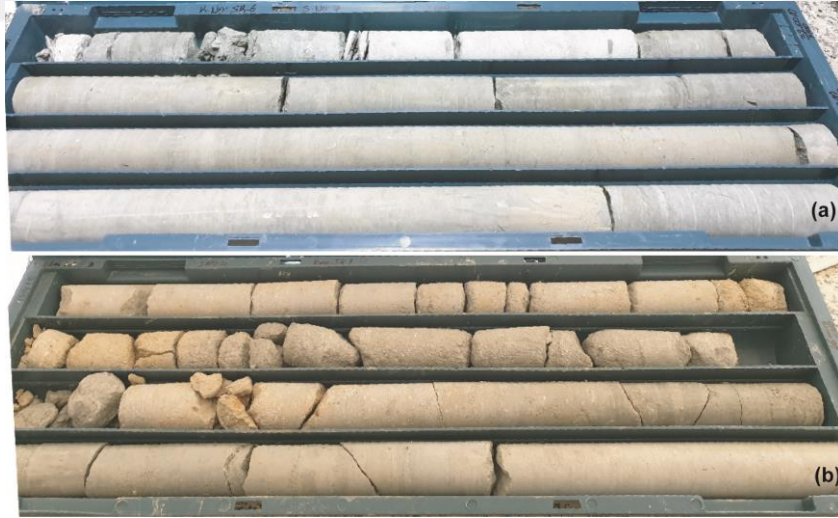
Şekil 5.1. Tüfit (a) ve killi kireçtaşı (b) örneklerinin derlendiği karot sandıkları
