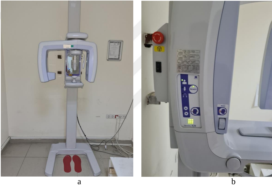
Resim 2. Panoramik Radyografi Cihazı a: Karşıdan Görünüm b: Komut Tablası Görünümü
