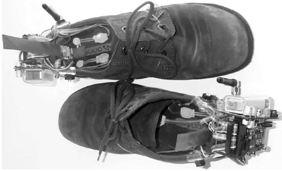
Şekil 2.4.2. Çözümün ayakkabıya monte edilmiş hali
