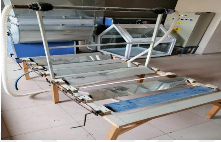
Şekil 2.26. Zincir dişli mekanizması (Çetiner, 2014)
