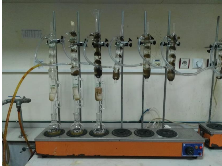
Şekil 3.7. Sığla yaprağının ham yağ içeriğini belirlemede kullanılan Soxhlet ünitesi
