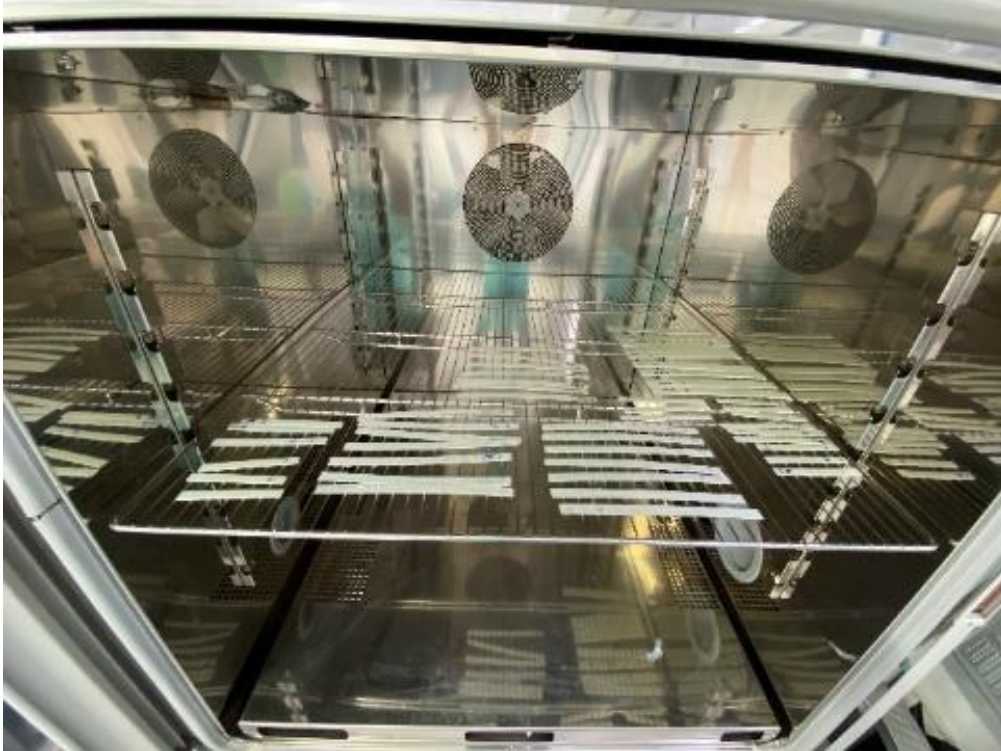
Şekil 4.11. Sıkıştırılmalı kalıplama ile üretilen GF/PA6 numunelerin kısa termal çevrimin etkisini görebilmek amacıyla çekme, üç nokta eğme ve impact test numuneleri iklimik kabinde
