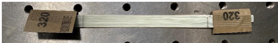
Şekil 4.13. ISO 527 standardının Tip B isterlerine göre hazırlanmış ve üzerine kayma durumunun kontrolü için işaretli kupon numune
