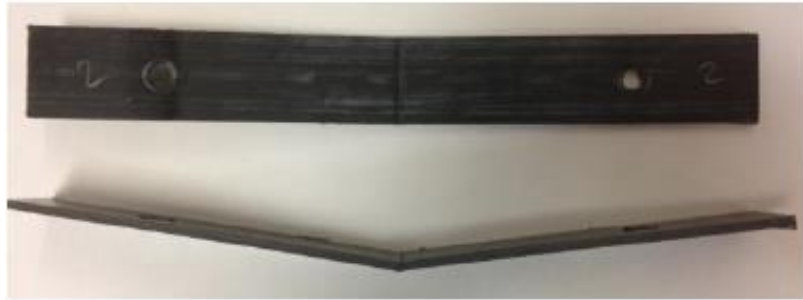
Şekil 3.6. GF/PA6 kompozitleri için yük ve yer değiştirme sonrası meydana gelen geometrik şekil (Boucher ve diğ., 2018)
