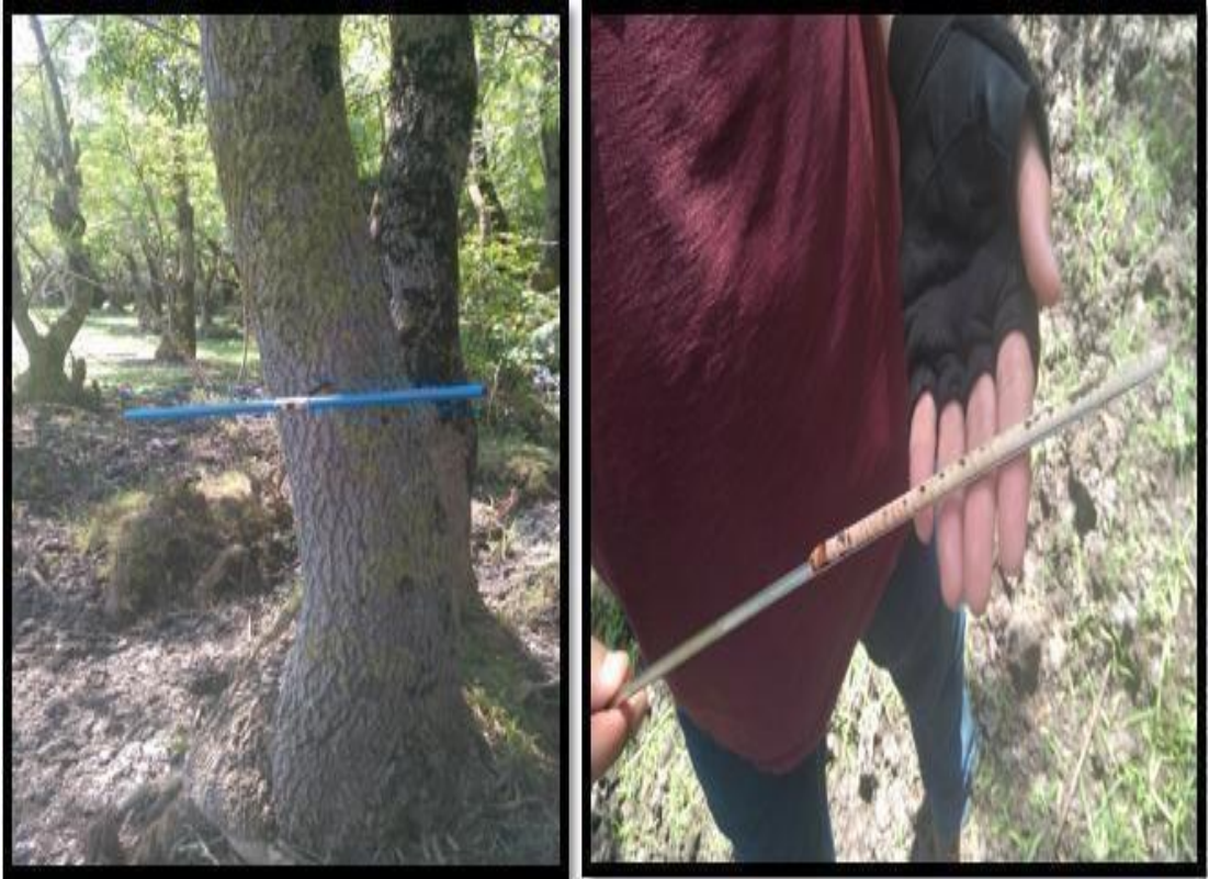
Şekil 2.12: Artım burgusu kullanılarak yaş kalemi alınması ve yaş tespiti yapılması.
