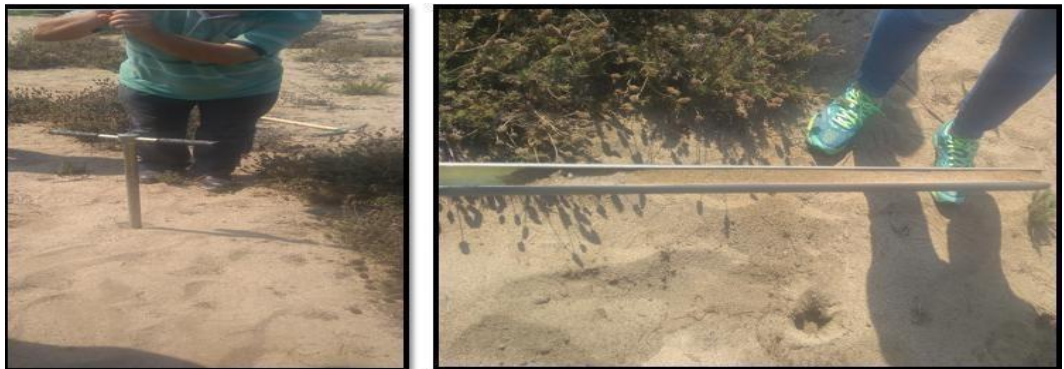
Şekil 2.16: Kumul alanda toprak burgusu yardımıyla toprak örneği alınması.
