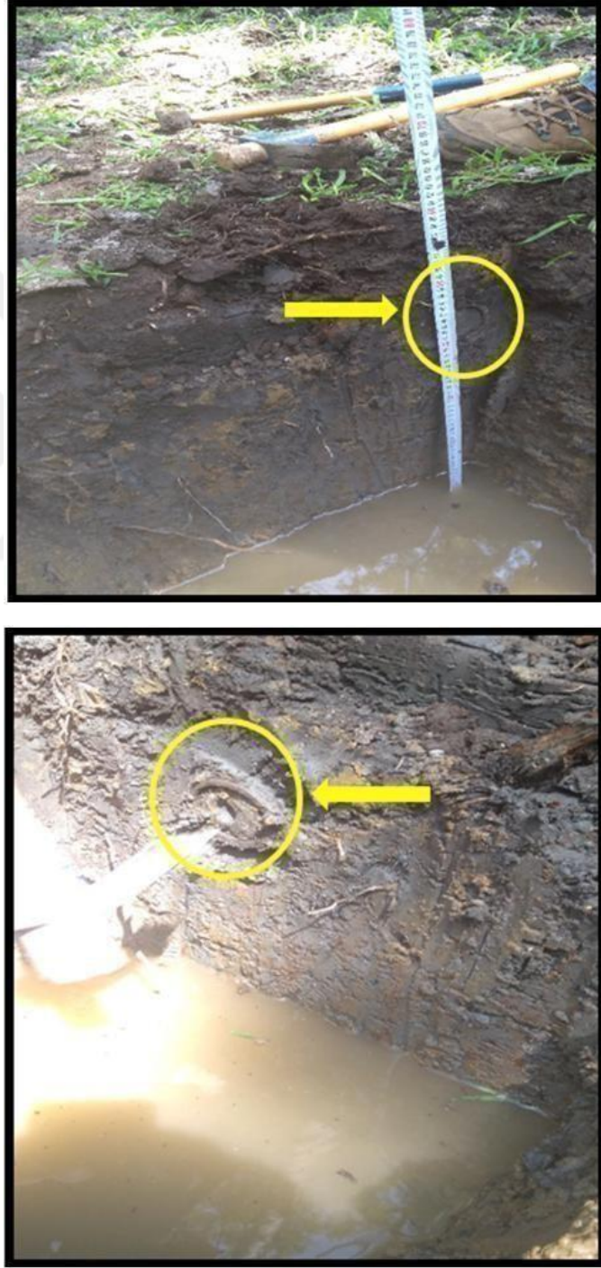
Şekil 2.14: Çelik silindir yardımıyla toprak örnekleme.
