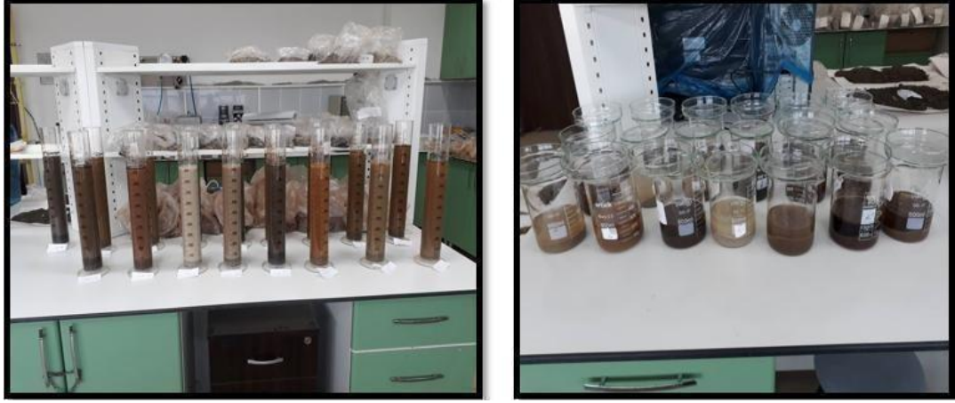
Şekil 2.24: Toprak örneklerinin tekstür analizinin yapılması.
