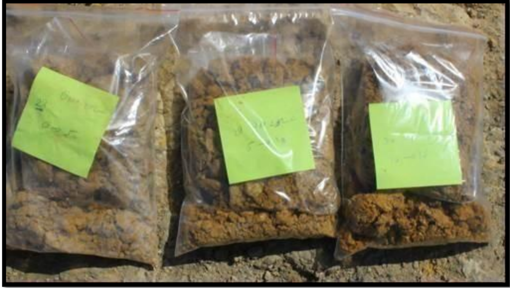
Şekil 2.17: Alınan toprak örneklerinin naylon torbalara konularak etiketlenmesi.
