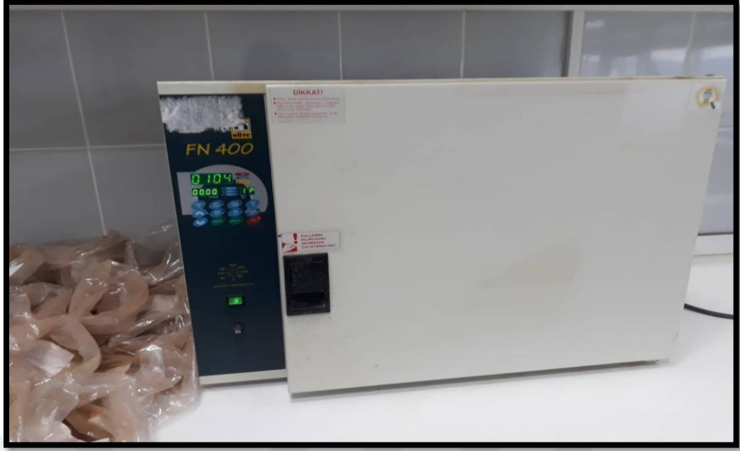
Şekil 2.19: Örneklerin fırın kurusu hale getirilmesi.
