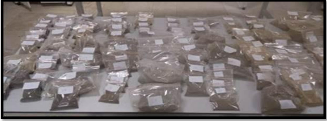
Şekil 2.21: Analize hazır hale getirilmiş 2 mm lik elekten geçirilmiş toprak örnekleri.
