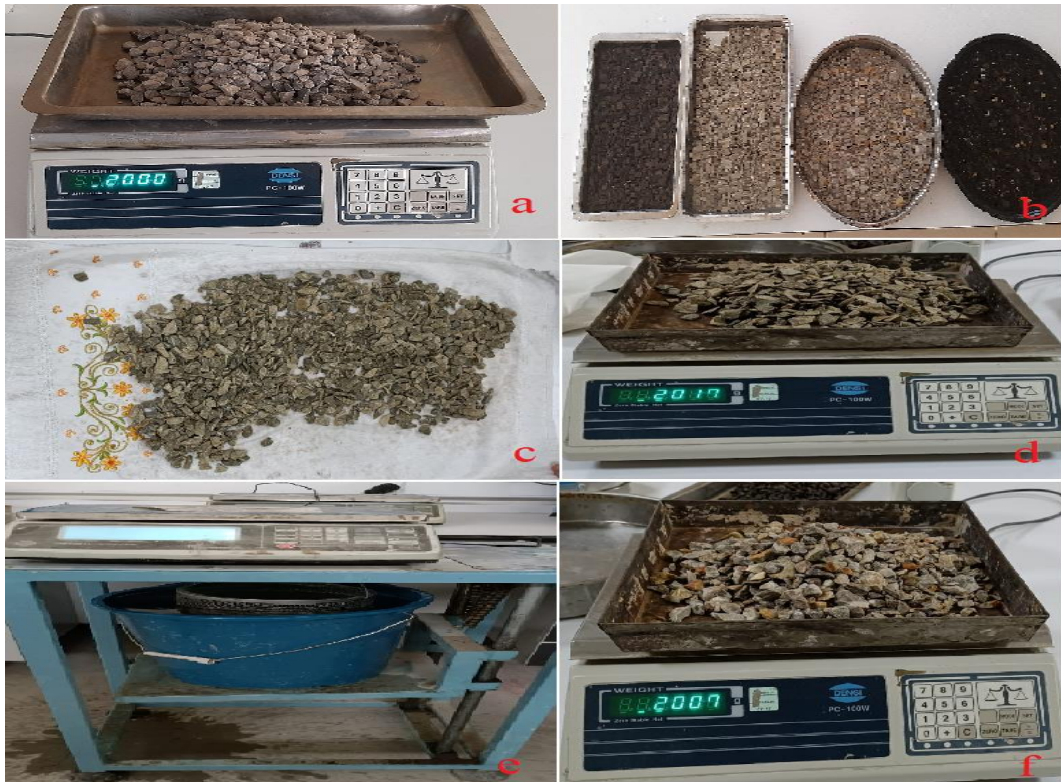
Şekil 4.3. İri Agregat Deney Aşamaları. a) Numunenin Hazırlanması, b) Numunelerin Suya Koyulması, c) Numunelerin Peçete Yardımıyla Kurutulması, d) Numunelerin Tartılması, e) Agregaların Tel Sepetle Su Kovaına Konulması, f) Numunelerin Etüvde Kurutulduktan Sonraki Tartımı
