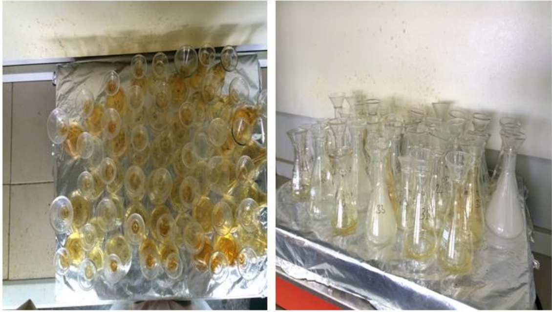
Şekil 3.28. Meyve ve yaprak örneklerinin yaş yakma metodu ile yakılarak ICP-OES cihazında okunmaya hazır hale getirilmesinden genel görünüm
