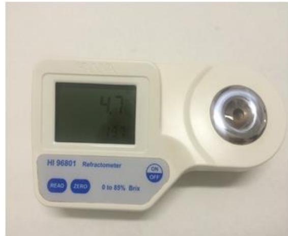
Şekil 3.32. Suda çözünabilir kuru madde miktarının ölçümünün yapıldığı refraktometre ve ölçümün yapılmasından genel bir görünüm
