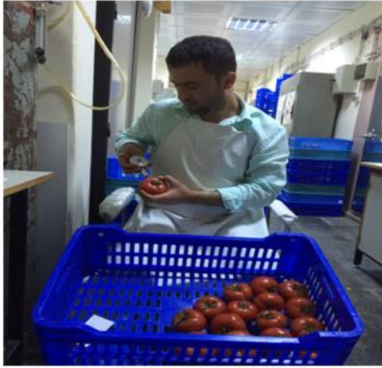
Şekil 3.34. Meyve eti sertliğinin ölçüldüğü penetrometre ve ölçümün yapılmasından genel bir görünüm
