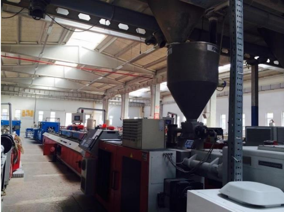
Şekil 3.2. Kompozitlerin hazırlanmasında kullanılan ekstrüder hattı.
