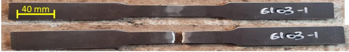
Şekil 7.12 A6G-1 numaralı parçanın çekme testi öncesi ve sonrası
