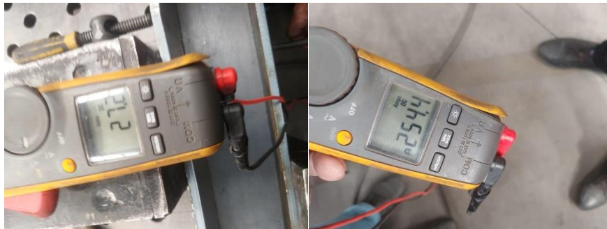
Şekil 6.4 Geleneksel kaynak makinesi ile yapılan köşe kaynağında ölçülen voltaj ve akım değerleri
