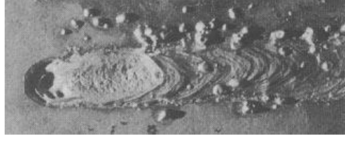
Şekil 2.36 Kaynak dikişinde sıçrıntı görseli [18].
