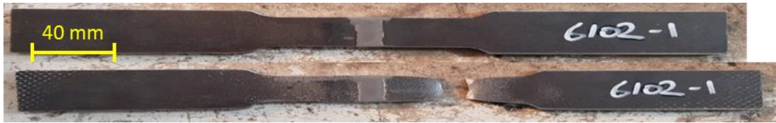
Şekil 7.10 A6Y-1 numaralı parçanın çekme testi öncesi ve sonrası
