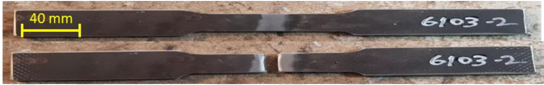
Şekil 7.13 A6G-2 numaralı parçanın çekme testi öncesi ve sonrası
