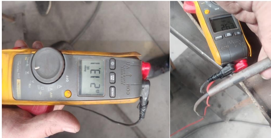
Şekil 6.7 Geleneksel kaynak makinesi ile yapılan aln kaynağında ölçülen akım ve voltaj değerleri
