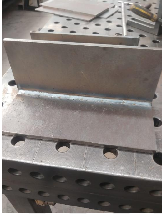
Şekil 6.5 Geleneksel kaynak makinesi ile yapılan köşe kaynağı görüntüsü
