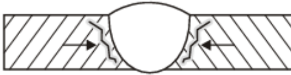
Şekil 2.32 Ana metalde yer alan çatlak görseli [21].
