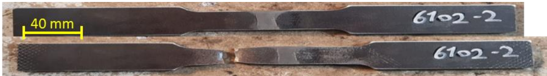
Şekil 7.11 A6Y-2 numaralı parçanın çekme testi öncesi ve sonrası
