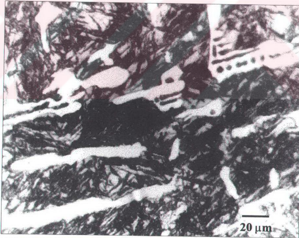
Şekil 7.53. Hiçbir alaşım elementi ilave edilmemiş 14 nolu numunenin 1050°C'da 6 saat ostenitlenip havada su verildikten sonra 250°C'da 6 saat temperlenmesi sonrasında elde edilen mikroyapısı.
