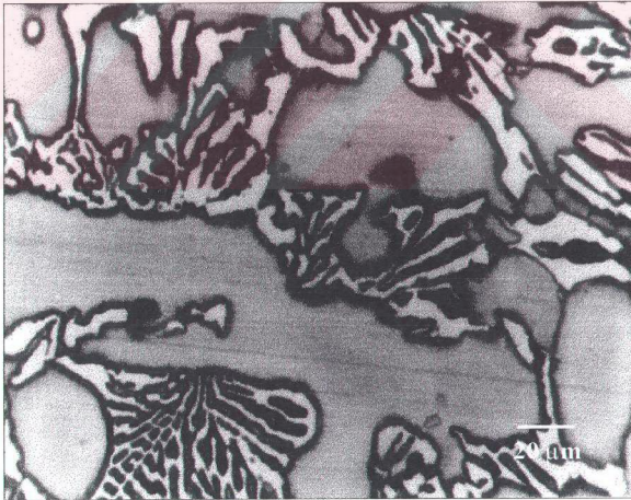
Şekil 7.10. %0,14 V ile alaşımlanmış 7 nolu numunenin döküm halindeki mikroyapısı.
