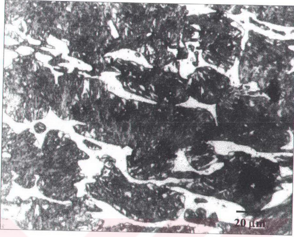
Şekil 7.40. Hiçbir alaşım elementi ilave edilmemiş 13 nolu numunenin 1050°C'da 6 saat süreyle ostenitlenip havada su verilmiş haldeki mikroyapısı.
