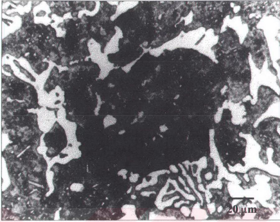
Şekil 7.19. %0,253 Ti ile alaşımlanmış 51 nolu numunenin 1000°C'da 6 saat süreyle ostenitlenmiş ve havada su verilmiş haldeki mikroyapısı.
