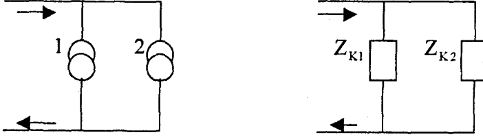
Şekil 5.3 Transformator merkezlerinin tam yükünün bölünmesi
