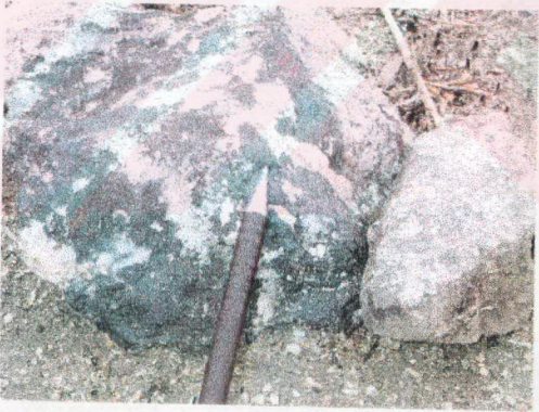
Şekil 2. 4: Silisçe zengin, yer yer breşik doku gösteren ve merccek şeklinde gelişmiş karbonat mineralleri içeren kontakt metamorfik zona ait el örneği
