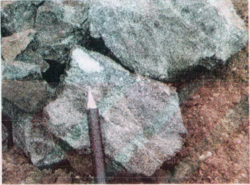
Şekil 2. 22: Kontakt metamorfizma izi taşıyan ve tıkHz yönlendirme göstermeyen fels dokusunun hakim olduđu kalsilikatik hornfels kayacına ait el örneđi
