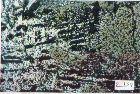
Şekil 4. 28: Hematit (beyaz) levhalarının incelenerek gang (gri) içinde nihayetlenmesi (T. N., h: hematit).
