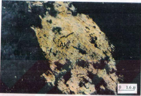
Şekil 2. 12: Granodiyoritlerde gözlenen lifsi yapıdaki aktinolit minerali (Ç. N., Ak: aktinolit, Ort: ortoklaz)
