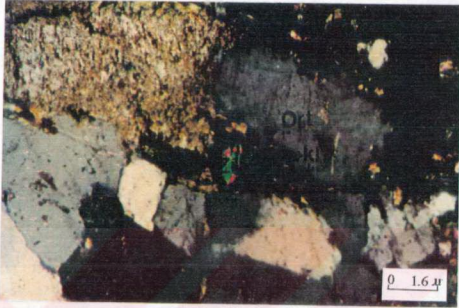
Şekil 2. 18: Tonalit kayacında gözlenen zirkon minerali (Ç. N., Zr: zirkon, Ort: ortoklaz, kl: klorit)
