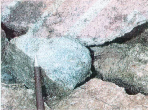
Şekil 2. 20: Çaltıpelerdeki granitporfirler içinde yer yer çok ince kristalli mafik minerallerce zengin fels zonuna ait el örneği
