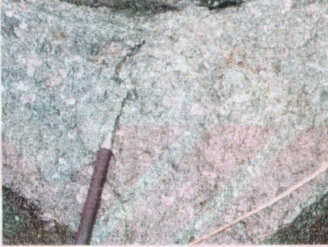
Şekil 2. 19: Alkali feldspat fenokristallerinin yaygın olarak gözlemlendiği granitporfir kayacı
