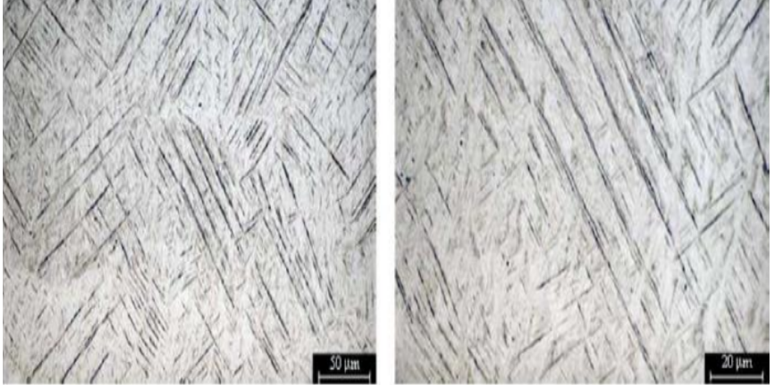
Şekil 3.4: SLE ile Üretilmiş Ti-6Al-4V Alaşımı Mikro Yapısı (Appavuravther, 2020).
