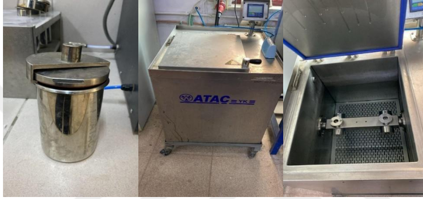
Şekil 3.10. Yıkama haslığı test cihazının görüntüsü
