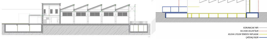
Şekil 5.37 Atölye Binası restorasyon koruma, yıkım ve yeniden yapım kararları (Müdahale Kararları ve Restorasyon Raporu).
