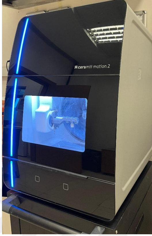
Şekil 3.7: Çalışmada kullanılan kazıma cihazı (Ceramill Motion 2; Amann Girrbach, Austria)
