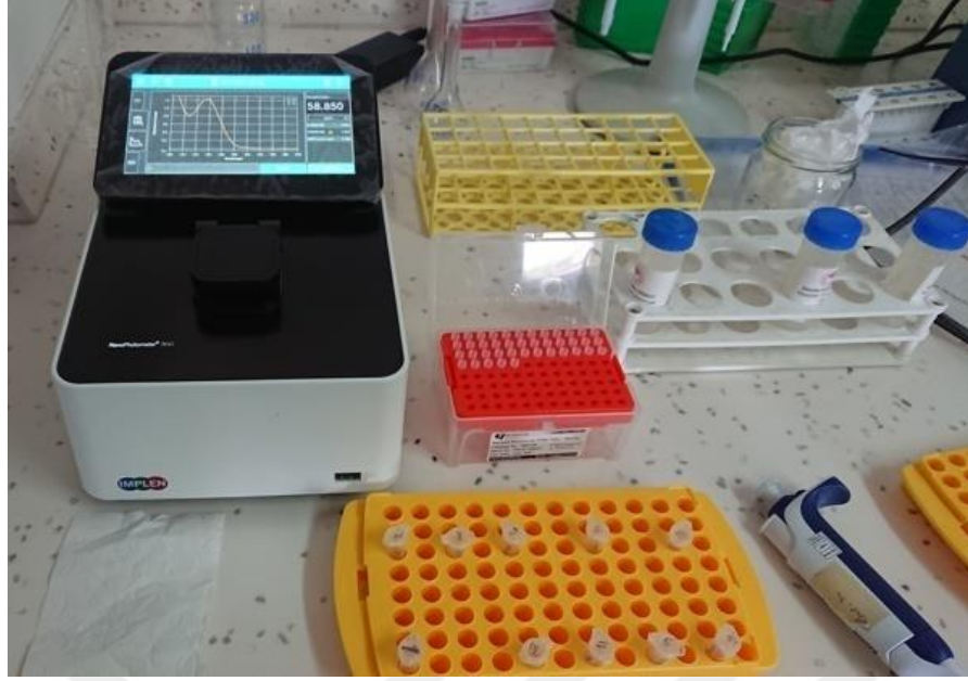
Şekil 3. 65. Spektrofotometre (NanoPhotometer NP80) cihazında saflık ölçümü
