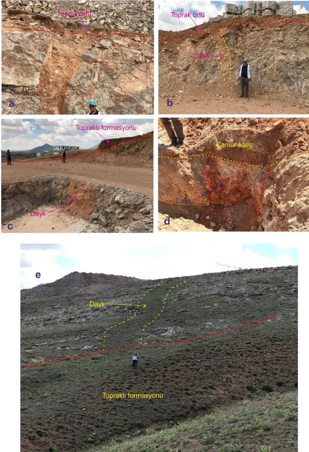
Şekil 4. 14. (a-b), Sedimanter daykların bitkisel toprak ile örtülmesi; (c-d), L5-20 nolu blokun temelinde izlenen ve Topraklı formasyonu tarafından örtülen dayk ve bu dayka ait kazıdan görünüm; (e), İnceleme alanın hemen batısında izlenen daykın Topraklı formasyonu tarafından örtülmesini gösteren fotoğraf. (Eren. Y, 2016)
