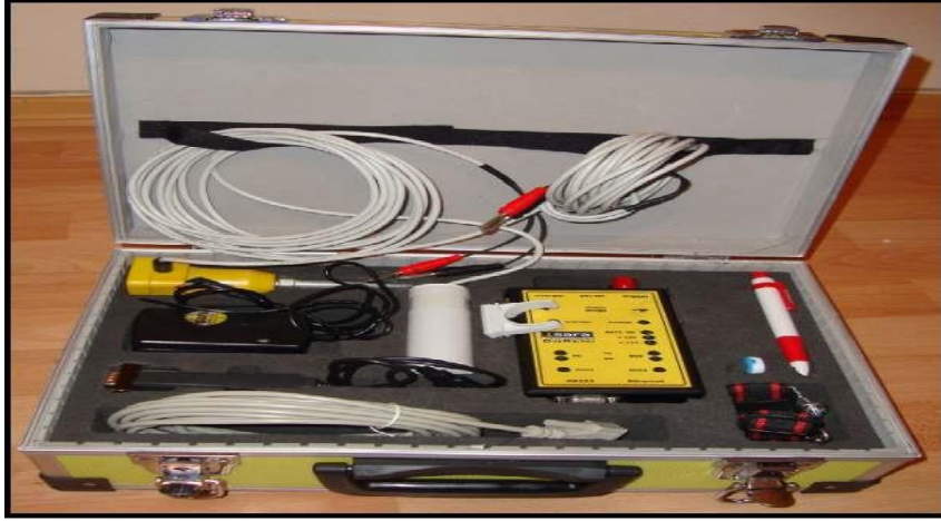
Şekil 3. 2. Jeofizik Çalışmalarda kullanılan SARA-DOREMI cihazı (Konya Zemin Ltd. Şti, 2025)
