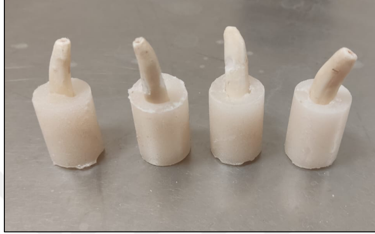
Şekil 2. 1. Akrilik rezin içine gömülmüş sığır dişleri
