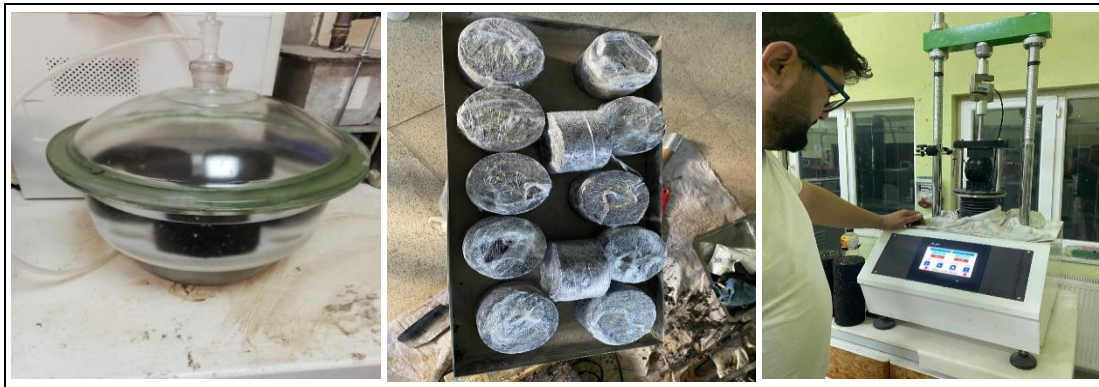
Şekil 3.14. Vakum uygulaması (a), streç film ile kaplama (b) ve ITS deneyi (c)
