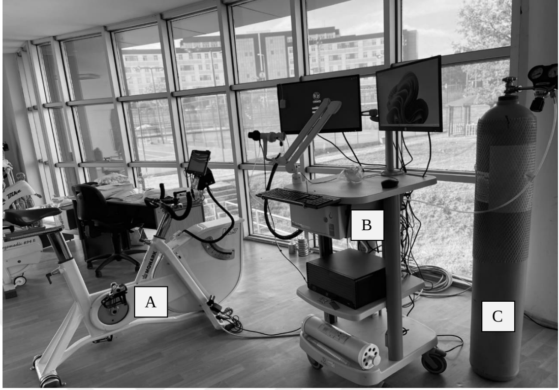
Şekil 3.2. Fizyolojik ölçümler için kurulum: A) LC7 bisiklet ergometresi B) Spirometrik ve kardiyopulmoner ölçümler için test cihazı ve C) CO karışımını içeren sıkıştırılmış gaz tüpü
