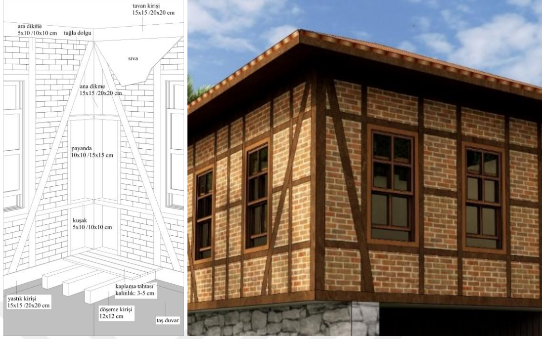
Şekil 3.49: Tuğla dolgulu hımiş sistem uygulaması [Yazar, 2024].
