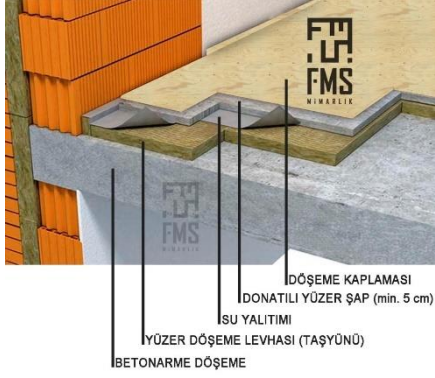
Şekil 2.4 Döşeme ısı yalıtım uygulama katmanları (URL- 4, 2025)
