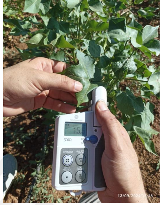
Şekil 3.8. Klorofil (SPAD değeri) ölçümü
