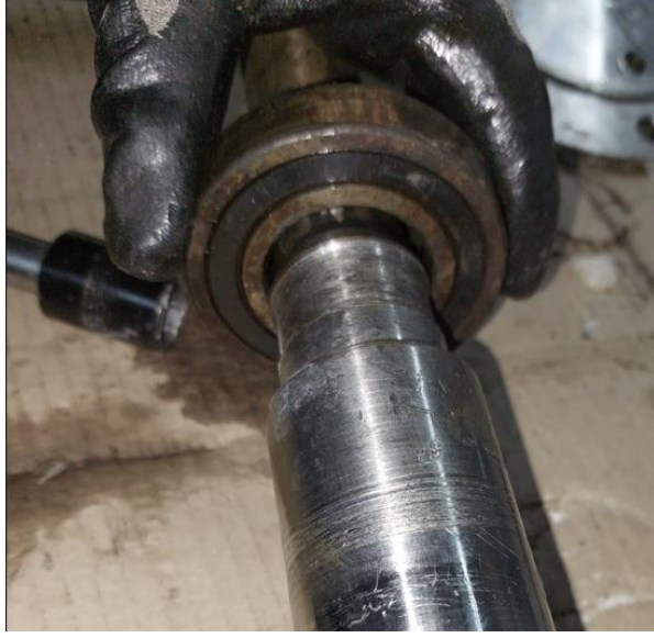
Şekil 4.38. Helezon Milindeki Rulman Boşluğu Arızası
