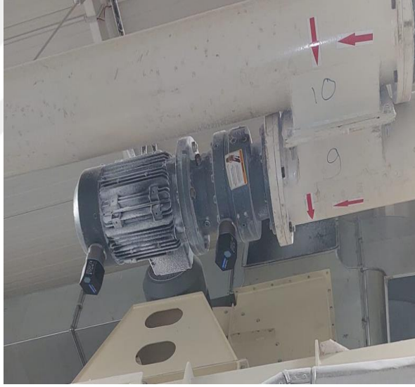
Şekil 4.6. Sıcaklık ve Titreşim Sensörünün Gövdeye Montajı
