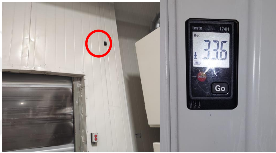
Şekil 4.9. Datalogger Görünümü ve Çalışma Ortamına Montajı
