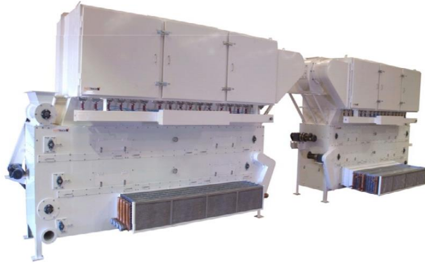
Şekil 2.5. Nişasta Şartlandırma Sistemi (Vorteks)
