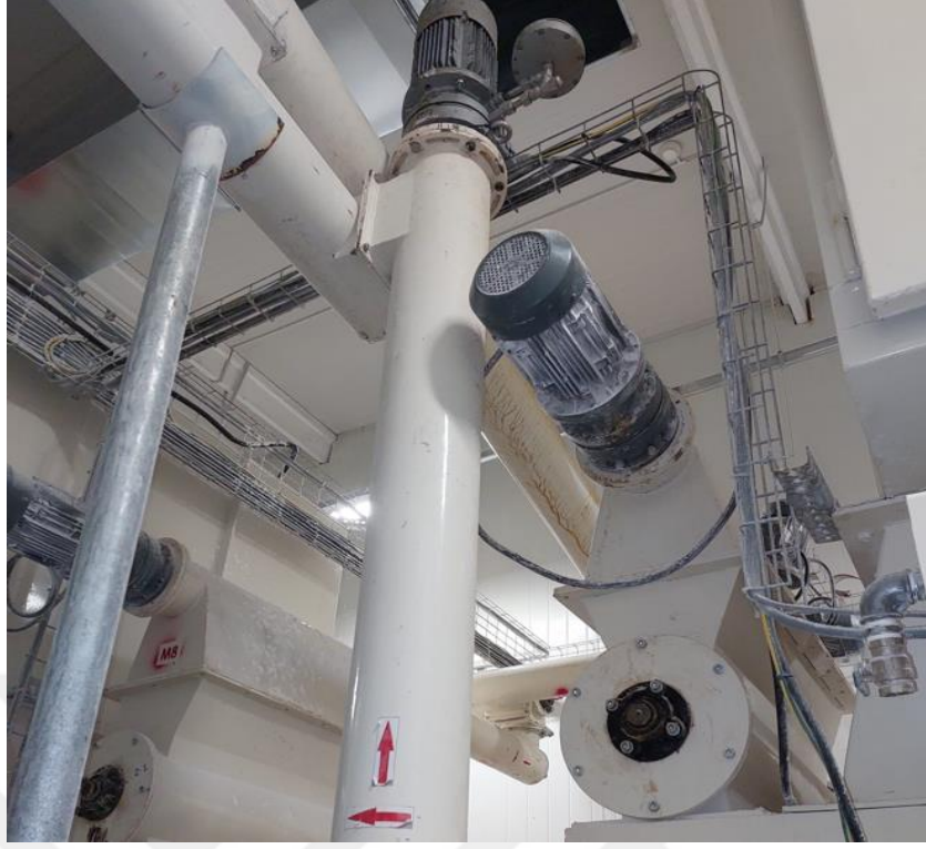
Şekil 2.6. Dikey ve Yatay Motorlu Helezon Grupları
