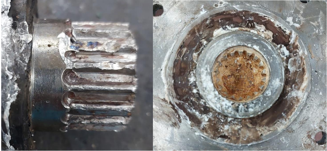
Şekil 4.37. Uzun Duruşa (Class 3) Sebep Olan Dişli Arızası
