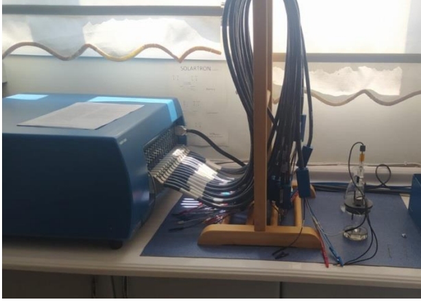
Şekil 3.12 Biologic VMP 300 potensiyostat cihazı ve deney düzeneği
