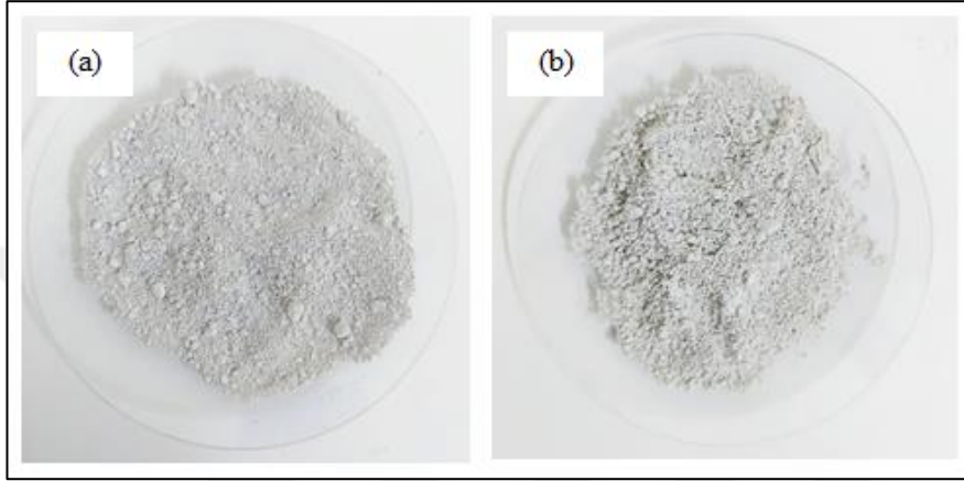
Şekil 4.48 (a) ChClMA , (b) ChClSA içinde çözünmeyen kurşun bileşiği
