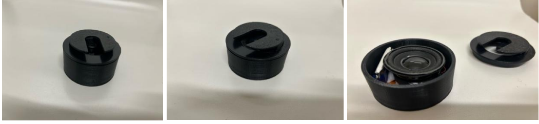
Şekil 3.13 Stetoskopta kullanılan hoparlör kutusu
