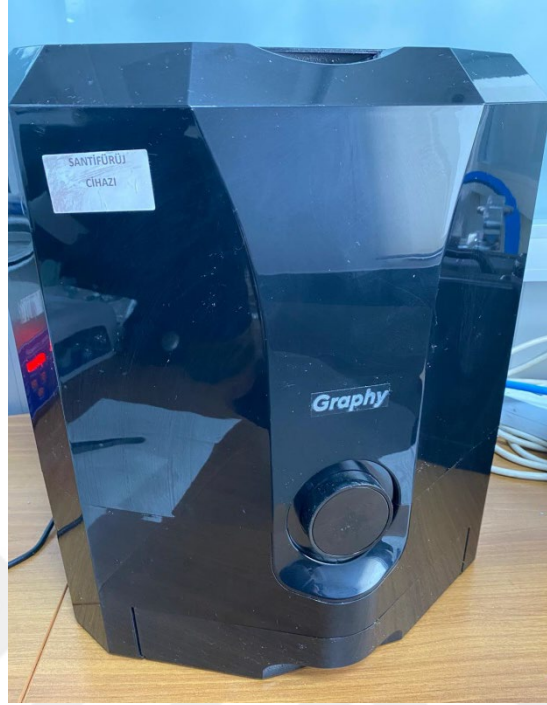
Şekil 3.10. Tera Harz Spinner santrifüj cihazı
