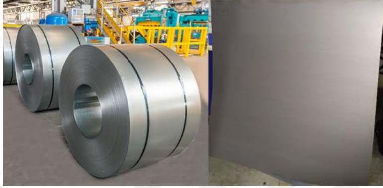
Şekil 2.24 : Rulo [92] ve 1m 2 silisli sac
