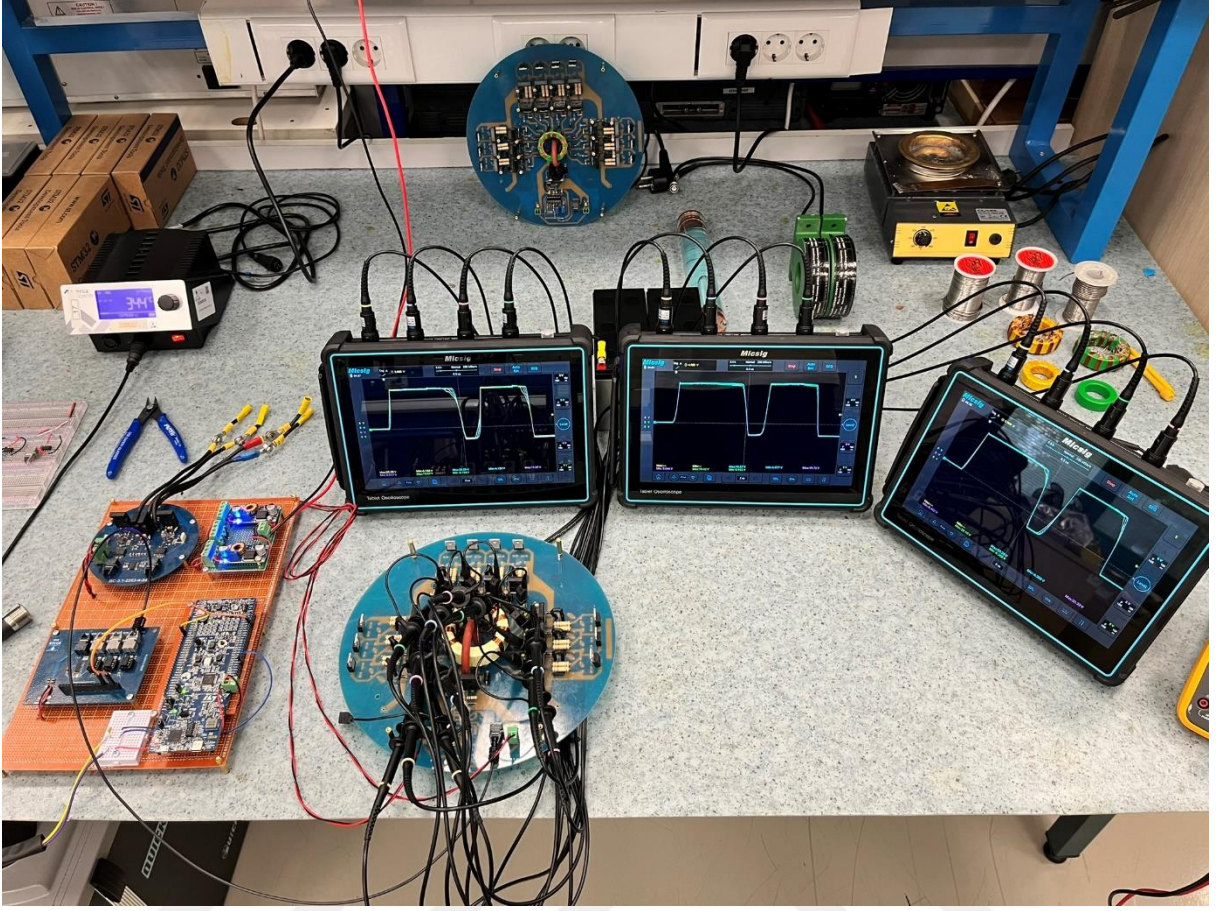
Şekil 4.23: İkincil sargı gerilimlerinin ölçümü için hazırlanan masaüstü devre kurulumu.
