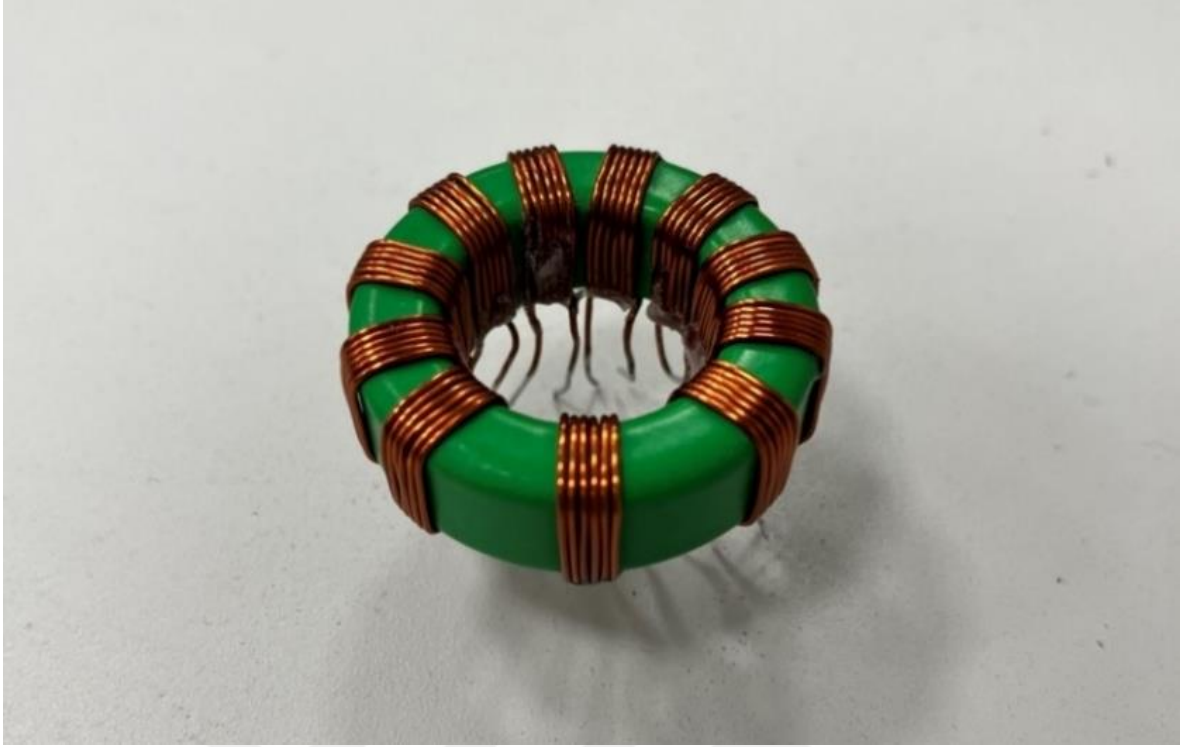
Şekil 4.1: Cosmo Ferrit CF139T4212C çekirdeği ile hazırlanan transformatör ( AL=2500nH ).
