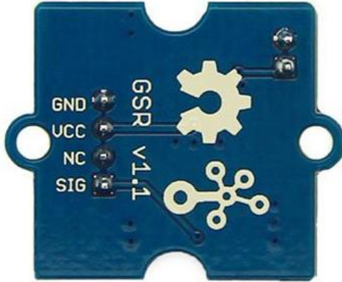
Şekil 5: Galvanik Deri Tepkisi (GSR) Ölçüm Sensörü Modülü Anakart (Arka Yüzü)
