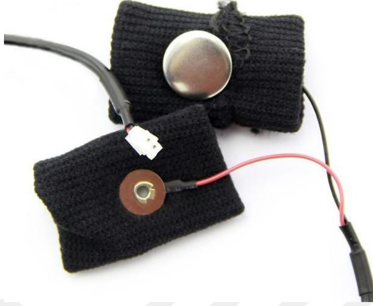
Şekil 6: Galvanik Deri Tepkisi (GSR) Ölçüm Sensörü Modülü Nikel Parmak Sensörü
