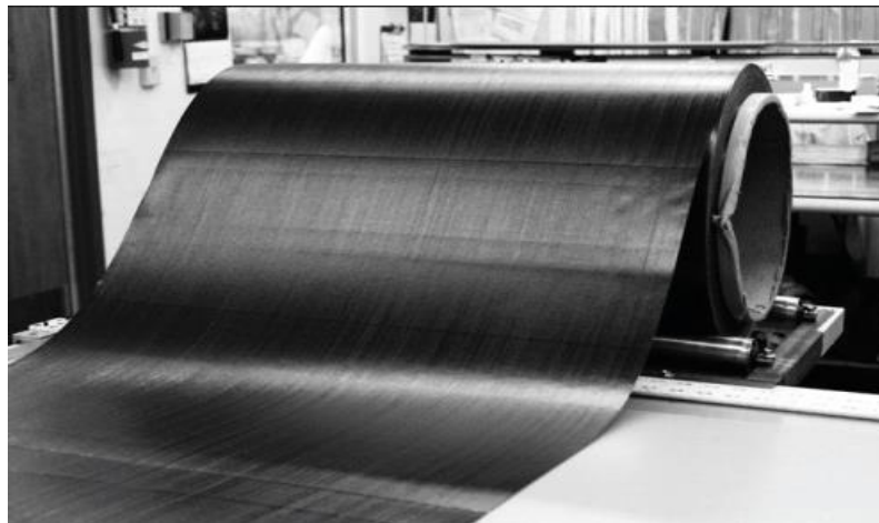
Şekil 3.2. Prepreg tabaka (Shabberhussain, 2024)
