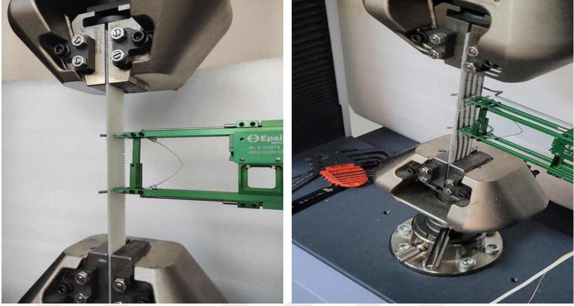
Şekil 4.26. Kompozit numunelere yönelik gerçekleştirilen çekme testi a) genel ve b) yakın görüntüsü
