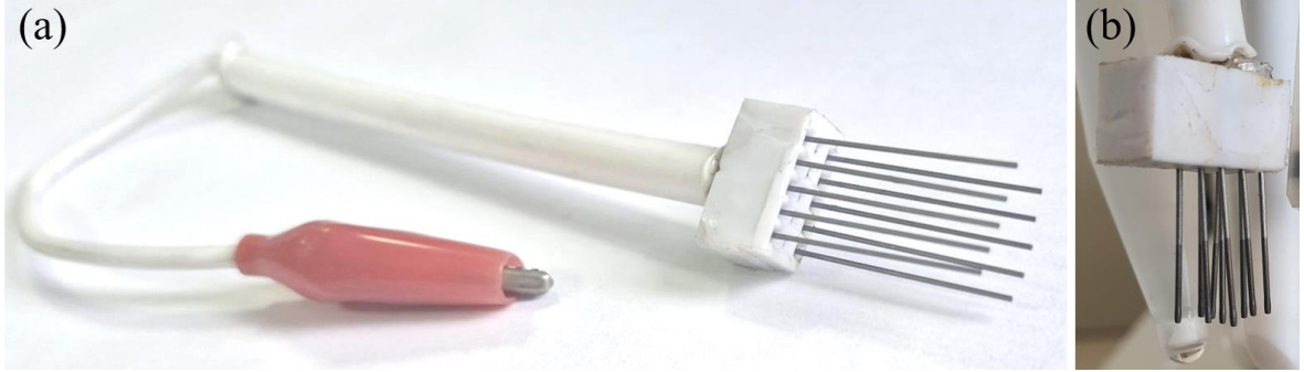
Şekil 8. Çoklu KGE tutucunun 10 adet KGE takılan (a) ve 6 adet KGE takılarak modifikasyon uygulanan (b) görselleri.
