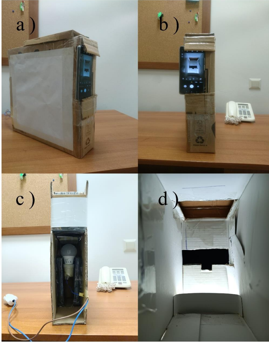
Şekil 3.2 Kayıt ortamının görüntüleri. a) Kayıt ortamının yan görüntüsü, b) Kayıt ortamının ön görüntüsü, c) Kayıt ortamının arka görüntüsü, d) Kayıt ortamının iç görüntüsü
