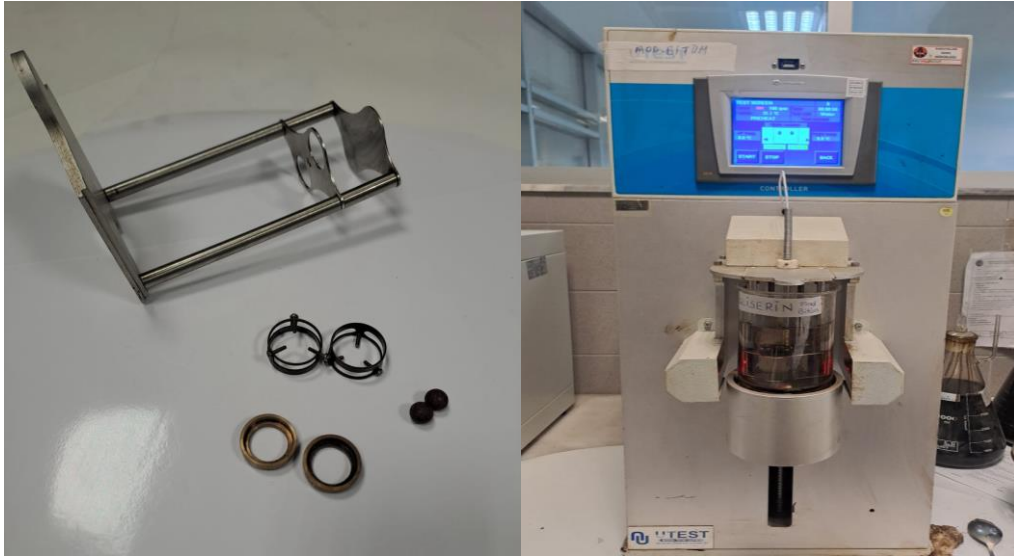
Şekil 4.4. Yumuşama noktası deney seti (UTEST, KGM 5. Bölge)
