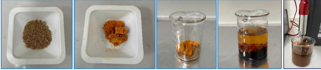
Şekil 3.3. Fe 3 O 4 nanopartiküllerin üretim aşamaları
