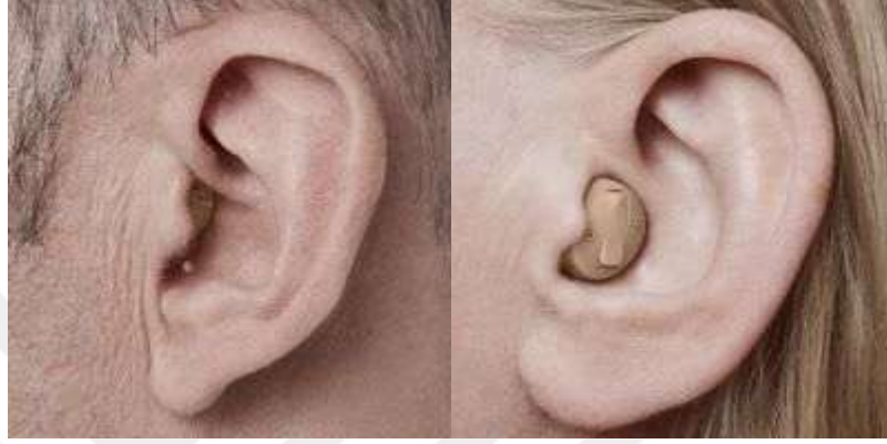
Şekil 33: ITE ve CIC model işitme cihazı örneği
