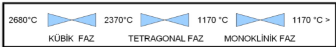
Resim 2.2. Zirkonyumun Kristal Fazları ve Dönüşüm Sıcaklıkları (43)
