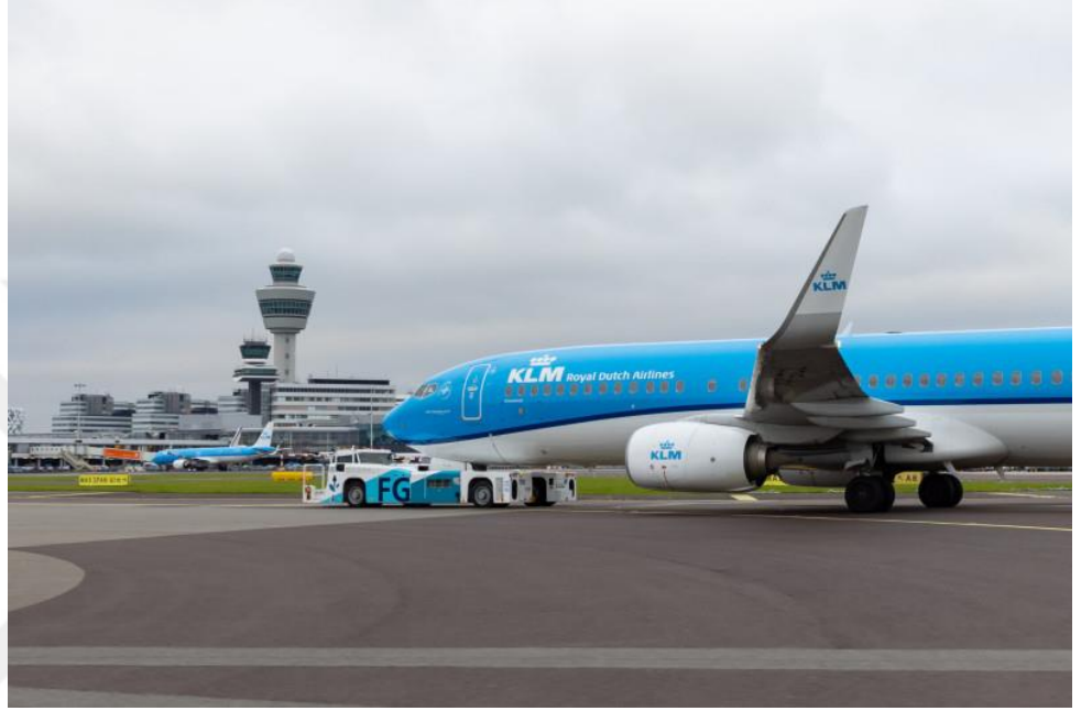
Şekil 5.1. Taxibot ile taksi yoluna getirilen KLM uçağı
