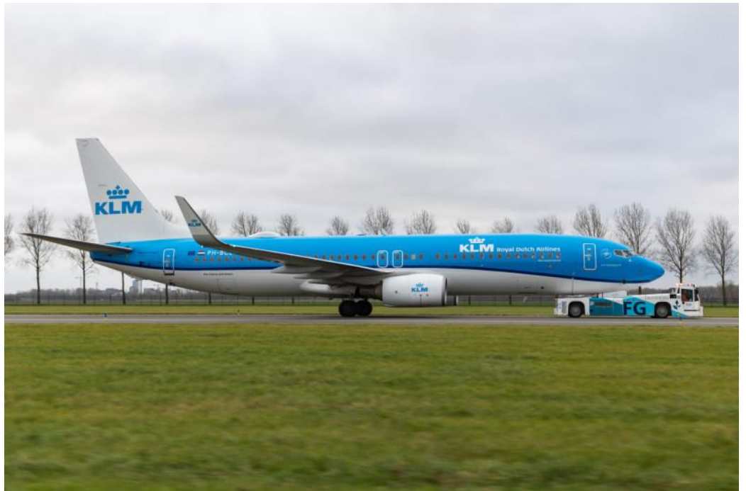
Şekil 5.2. Taxibot ile taksi yapan KLM uçağı
