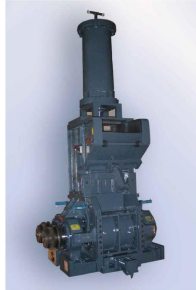
Şekil 2.40. Banbury karıştırıcı ve şematik gösterimi (Megep, 2011a)
