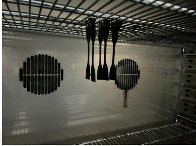
Şekil 3.13. Etüvde içinde bulunan havada yaşlandırma numuneleri
