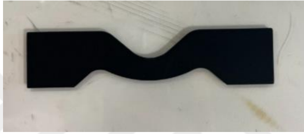
Şekil 3.12. Yırtılma testi numunesi
