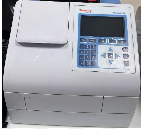
Şekil 3.2. Tez çalışmaları süresince kullanılan UV-VIS spektroskopi cihazı.
